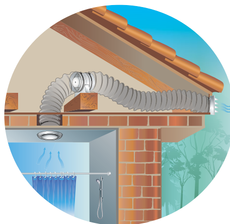
VKOK fan cottage ventilation example
